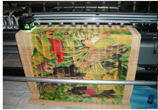
4 .att. Bambusa žalūziju apdruka ar NEO UV LED tehnoloģiju ( www.vava.lv )
